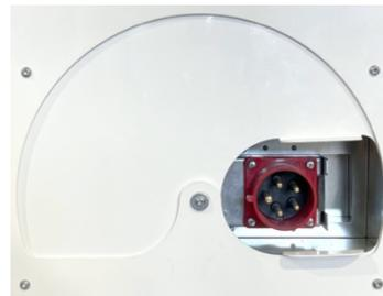
Beim **energyRANGY multi 22** sind die drei Möglichkeiten 16 - A/230V~ (max. 3,5 kW), 16 A/400V 3N~ (max. 11 kW) und 32 A/400V 3N~ (max. 22 kW). Wählen Sie den richtigen Anschluss für die Stromversorgung über die drehbare Blende an der Geräteseite aus und schließen Sie die Stromversorgungsleitung an die mobile Elektroheizzentrale an.
