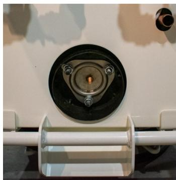
Unter dem Gerät befindet sich eine Wartungsöffnung, nach deren Öffnung Sie mit einem am KFE-Hahn des Rücklaufes angeschlossenen Schlauch Rostschlamm aus dem Boiler herauspülen können. **Verbinden Sie dabei Vor- und Rücklauf mit einem Schlauch oder verschließen Sie sie mit Kappen.**
