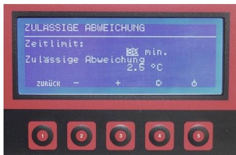
Bei dieser Betriebsart läuft das Programm in Temperaturstufen ab. Wenn eine neue Temperatur vorgegeben wird, kann es einige Zeit dauern, bis die mobile Heizzentrale das System auf die neue Temperatur aufgeheizt hat. Im ersten Menüpunkt geben Sie ein, nach welcher Zeit die Abweichung von der Solltemperatur kleiner als der eingegebene Wert sein muss. Ist dies nicht der Fall, wird eine Warnung angezeigt, das Programm läuft aber weiter.
