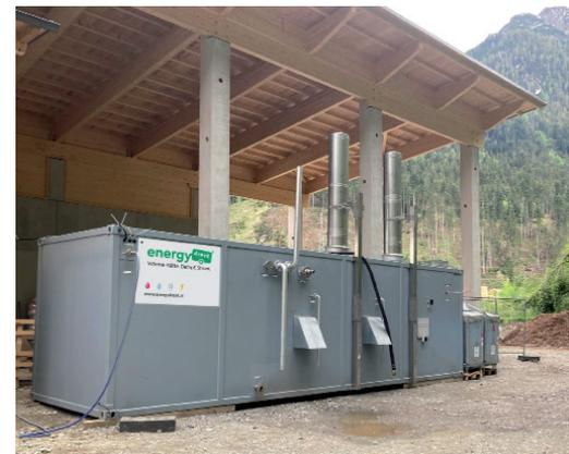
Latschenölproduktion mit einer energyUNIT Dampf 600 kg/h
