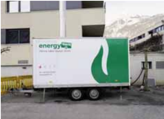
600 kW Wärme für Noteinsatz in Münster.
