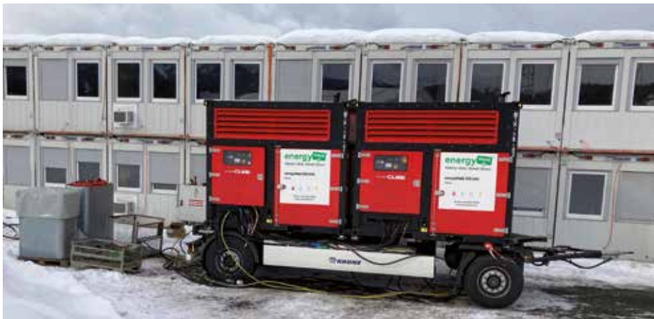
Noteinsatz nach einem „Baustellen-Blackout“ in Kärnten mit einem energyMOBIL Strom mit 1.000 kVA.
